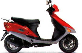
SJ 50 Bali Gebläsegekühlter Einzylinder-Zweitaktmotor mit Katalysator, 49 cm 3 , 3,1 kW (4,2 PS) bei 5.750 min -1 , 5,1 Nm bei 5.750 min -1 , Sitzhöhe 775 mm, 7 ltr Tankinhalt, Trockengewicht 87 kg
