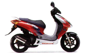
NEU X8R-S Gebläsegekühlter Einzylinder-Zweitaktmotor mit Katalysator, 49 cm 3 , Sitzhöhe 820 mm, 6 ltr Tankinhalt, Trockengewicht 92 kg, Ende April '98 lieferbar (Endgültige technische Daten lagen bei Drucklegung noch nicht vor.)
