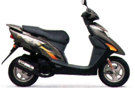
SFX 50 Gebläsegekühlter Einzylinder-Zweitaktmotor mit Katalysator, 49 cm 3 , 2,8 kW (3,8 PS) bei 6.000 min -1 , 4,6 Nm bei 5.500 min -1 , Sitzhöhe 755 mm, 6 ltr Tankinhalt, Trockengewicht 73 kg, ab April '98 lieferbar
