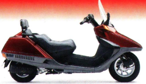
CN 250 Helix Flüssigkeitsgekühlter Einzylinder-Viertaktmotor, 244 cm 3 , 13 kW (17 PS) bei 7.000 min -1 , 20,5 Nm bei 5.000 min -1 , Sitzhöhe 665 mm, 12 ltr Tankinhalt, Trockengewicht 156 kg
