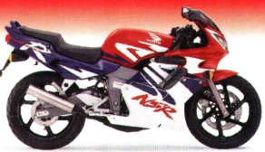
NSR 125R Flüssigkeitsgekühlter Einzylinder-Zweitaktmotor, 125 cm 3 , 11 kW (15 PS) bei 9500 min -1 , 15 Nm bei 8000 min -1 , Sitzhöhe 790 mm, 13 ltr Tankinhalt, Trockengewicht 132 kg
