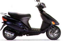
SJ 100EX Bali Gebläsegekühlter Einzylinder-Zweitaktmotor, 101 cm 3 , 6,2 kW (8,4 PS) bei 6.750 min -1 , 9,1 Nm bei 6.000 min -1 , Sitzhöhe 775 mm, 7 ltr Tankinhalt, Trockengewicht 93 kg
