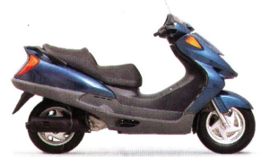
NEU FES 125 Pantheon Flüssigkeitsgekühlter Einzylinder-Zweitaktmotor mit Katalysator, 125 cm 3 , 11 kW (15 PS) bei 7.000 min -1 , 14,7 Nm bei 6.500 min -1 , Sitzhöhe 745 mm, 12 ltr Tankinhalt, Trockengewicht 144,5 kg, ab Mai '98 lieferbar (Endgültige technische Daten lagen bei Drucklegung noch nicht vor.)
