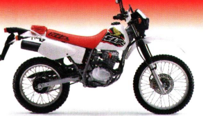
NEU XLR 125R Fahrtwindgekühlter Einzylinder-Viertaktmotor, 124 cm 3 , 8,4 kW (11,4 PS) bei 8.250 min -1 , 10,5 Nm bei 7.000 min -1 , Sitzhöhe 860 mm, 9 ltr Tankinhalt, Trockengewicht 119 kg
