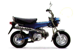
ST 50 Dax Fahrtwindgekühlter Einzylinder-Viertaktmotor, 49 cm 3 , 1,8 kW (2,4 PS) bei 7.000 min -1 , 3,0 Nm bei 4.500 min -1 , Sitzhöhe 740 mm, 2,5 ltr Tankinhalt, Trockengewicht 72 kg
