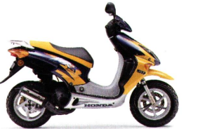
NEU X8R-X Gebläsegekühlter Einzylinder-Zweitaktmotor mit Katalysator, 49 cm 3 , Sitzhöhe 820 mm, 6 ltr Tankinhalt, Trockengewicht 92 kg, Ende April '98 lieferbar (Endgültige technische Daten lagen bei Drucklegung noch nicht vor.)
