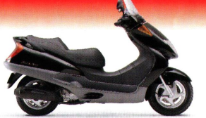
NEU FES 250 Foresight Flüssigkeitsgekühlter Einzylinder-Viertaktmotor, 249 cm 3 , 14 kW (19 PS) bei 7.000 min -1 , 21 Nm bei 5.500 min -1 , Sitzhöhe 745 mm, 12 ltr Tankinhalt, Trockengewicht 150 kg
