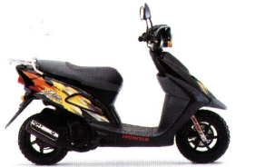
NEU SXR Gebläsegekühlter Einzylinder-Zweitaktmotor mit Katalysator, 49 cm 3 , 2,8 kW (3,8 PS) bei 6.000 min -1 , 4,6 Nm bei 6.000 min -1 , Sitzhöhe 755 mm, 6 ltr Tankinhalt, Trockengewicht 72 kg, ab April '98 lieferbar (Endgültige technische Daten lagen bei Drucklegung noch nicht vor.)
