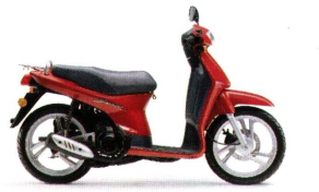
SH 50 Scoopy Gebläsegekühlter Einzylinder-Zweitaktmotor mit Katalysator, 49 cm 3 , 2,5 kW (3,4 PS) bei 6.500 min -1 , 3,8 Nm bei 6.500 min -1 , Sitzhöhe 765 mm, 6,3 ltr Tankinhalt, Trockengewicht 82 kg
