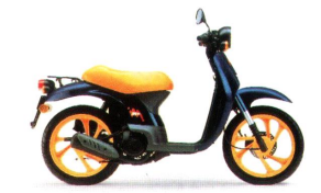
NEU SGX 50 Sky Gebläsegekühlter Einzylinder-Zweitaktmotor mit Katalysator, 49 cm 3 , 2,2 kW (3 PS) bei 6.250 min -1 , 3,4 Nm bei 6.000 min -1 , Sitzhöhe 775 mm, 4,5 ltr Tankinhalt, Trockengewicht 71 kg
