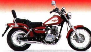
CA 125 Rebel Fahrtwindgekühlter Zweizylinder-Viertakt-Reihenmotor, 124 cm 3 , 8,1 kW (11 PS) bei 9.500 min -1 , 9,1 Nm bei 6.000 min -1 , Sitzhöhe 675 mm, 10 ltr Tankinhalt, Trockengewicht 140 kg
