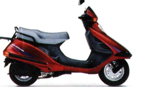
CH 125 Spacy Flüssigkeitsgekühlter Einzylinder-Viertaktmotor, 125 cm 3 , 7,2 kW (9,8 PS) bei 7.500 min -1 , 10,6 Nm bei 6.000 min -1 , Sitzhöhe 770 mm, 8 ltr Tankinhalt, Trockengewicht 109 kg
